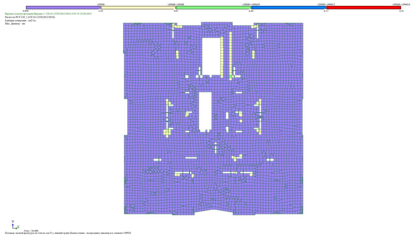
Рисунок 29. Плита типового этажа. Армирование нижней грани в направлении X
