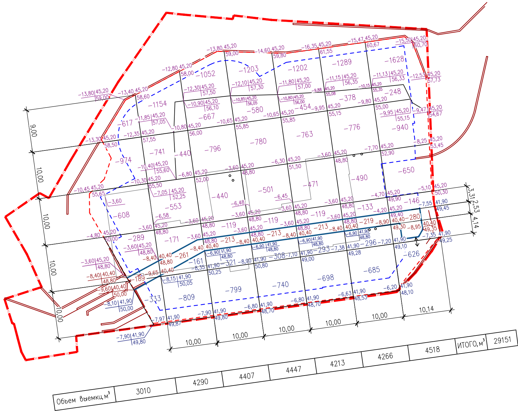
План земляных масс – выемка под котлован
