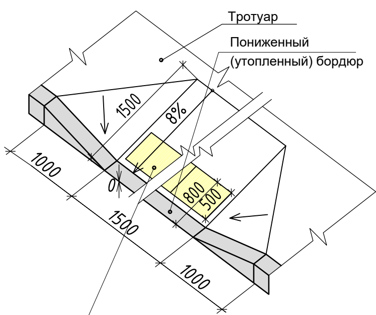
ДЕТАЛЬ УСТРОЙСТВА ПОНИЖЕННОГО БОРДЮРА И1
