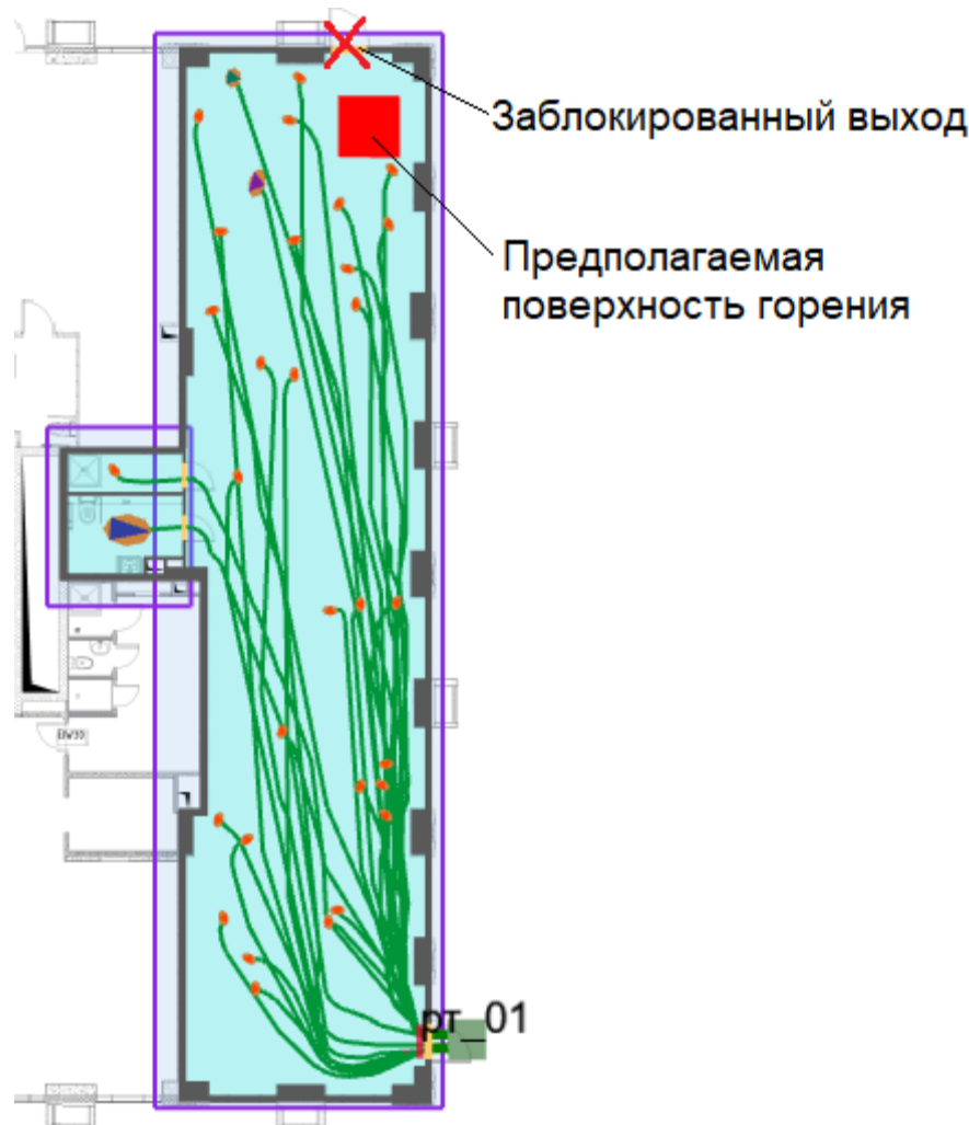
Рисунок 222 – План 1-го этажа и нанесенная на него расчетная (принципиальная) схема эвакуации
