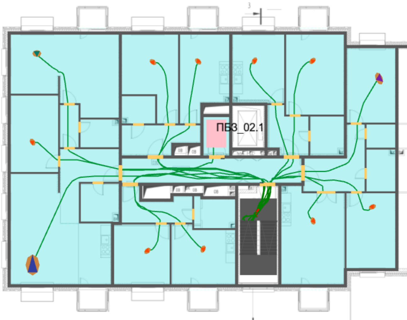
Рисунок 31 – План 2-го этажа и нанесенная на него расчетная (принципиальная) схема эвакуации
