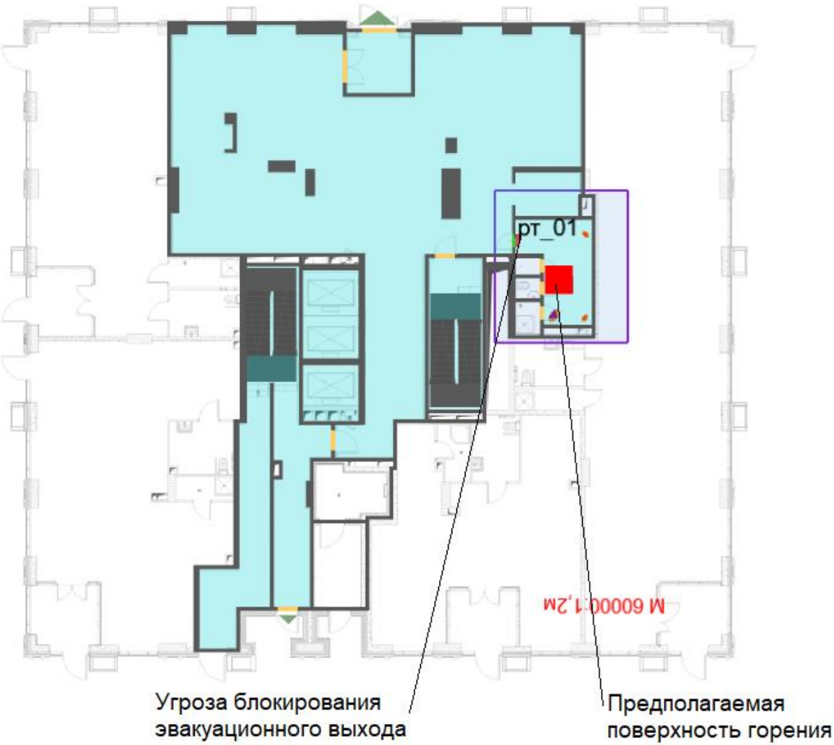
Рисунок: 167 – Компьютерная модель 1-го этажа с предполагаемой поверхностью горения и нанесенными расчётными точками
