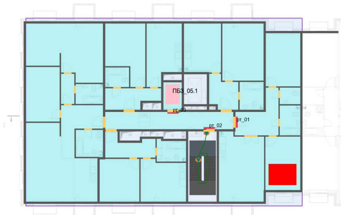
Рисунок 35 – План 5-го этажа и нанесенная на него расчетная (принципиальная) схема эвакуации (в момент полной эвакуации с этажа - 4 мин. 41 с.)
