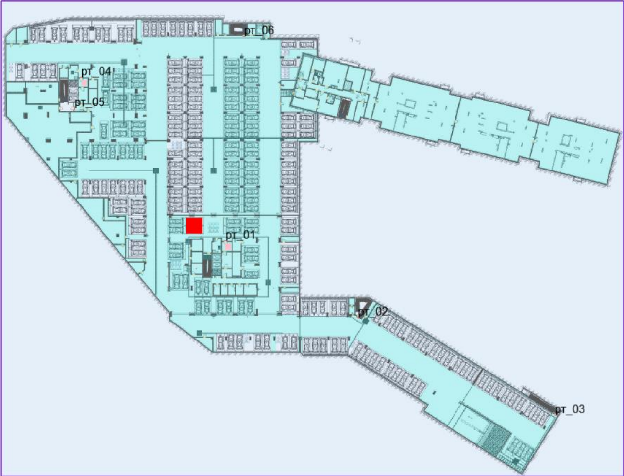
Рисунок 82 – План «минус» 1-го этажа и нанесенная на него расчетная (принципиальная) схема эвакуации (в момент полной эвакуации с этажа - 2 мин. 21 с.)
