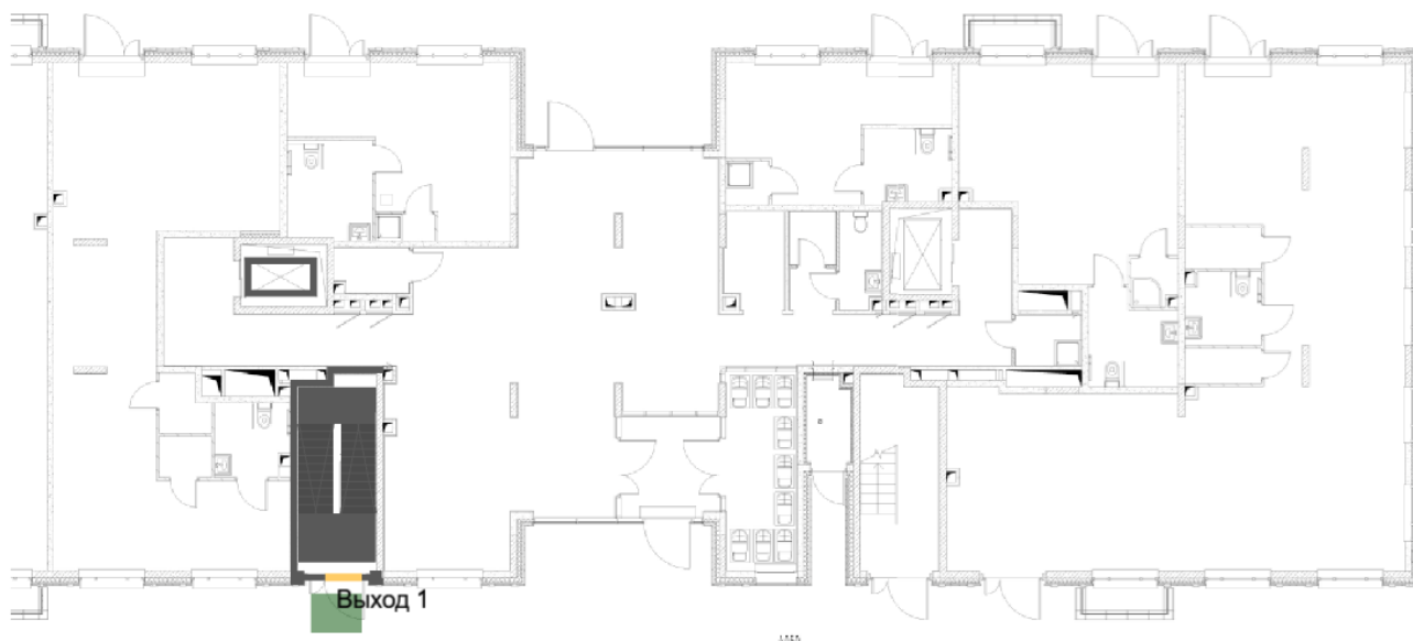
Рисунок 248 – План 1-го этажа и нанесенная на него расчетная (принципиальная) схема эвакуации
