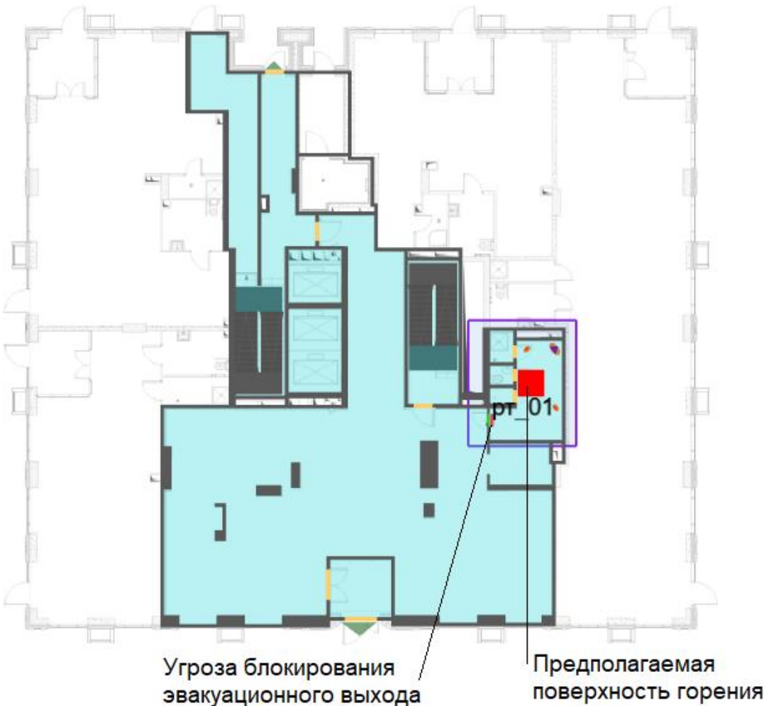
Рисунок: 155 – Компьютерная модель 1-го этажа с предполагаемой поверхностью горения и нанесенными расчётными точками
